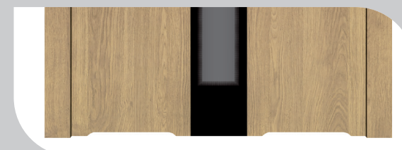
podcięcie wentylacyjne h-10 mm symetryczne podwójne
